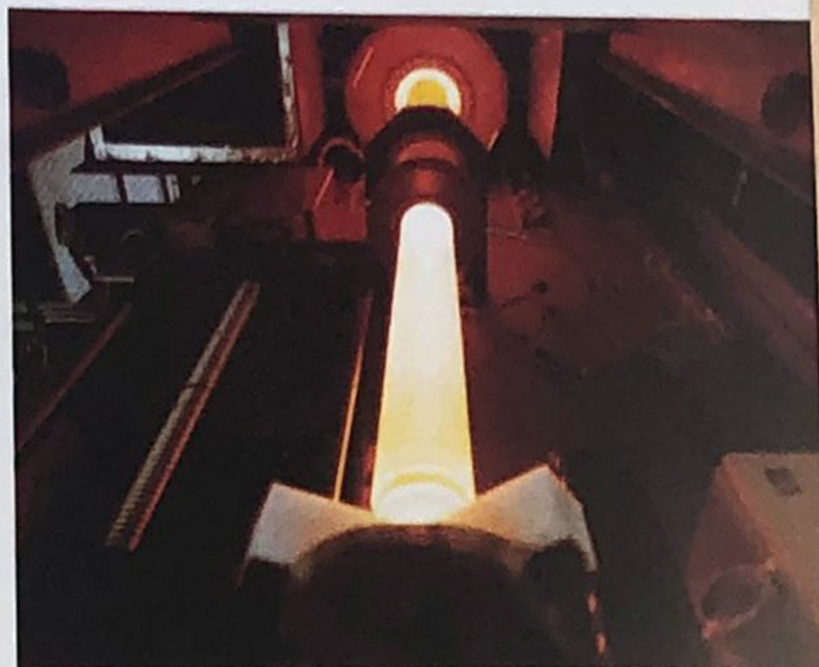
Proceso de fabricación de la preforma, según la técnica OVD.
